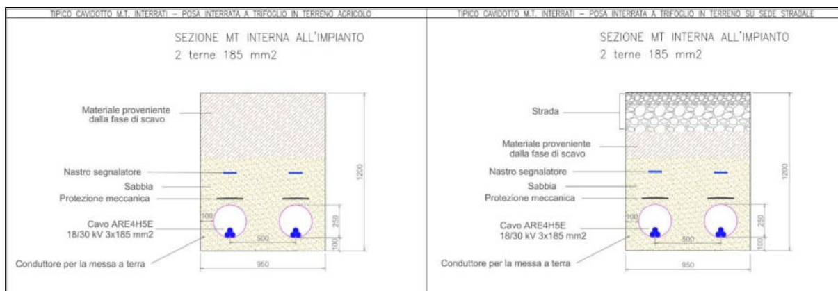
Figura 83 - Sezione scavi cavidotti 30 kV
